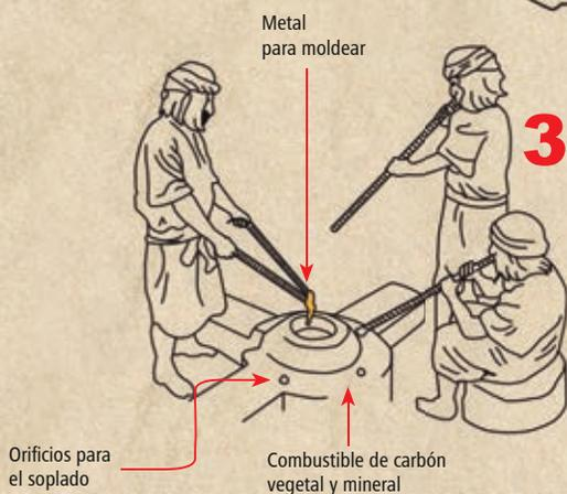
**3** Introducido el **mineral más fundente** en el horno de barro, empieza el trabajo arduo de los sopladores para alcanzar la temperatura ideal, alrededor de **1100 grados**, al que podían llegar después de tres horas de trabajo.
