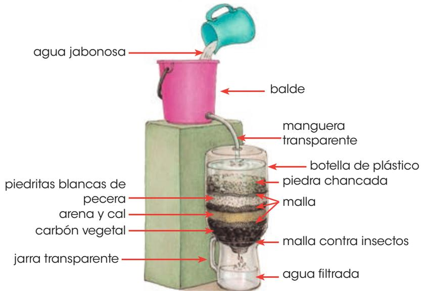
Los resultados demostraron que el filtro puede elaborarse con materiales 100 % reciclables, de bajo costo y fácil acceso, por lo que su uso es posible en cualquier hogar. El filtro tiene la capacidad de retener las impurezas producto del lavado por fuerzas sencillas de infiltración y capilaridad. Esta agua filtrada no es potable, pero sirve para otros usos domésticos.
